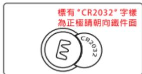
4. 換上新的CR2032電池，確認電池極性並裝回後則LED開始閃爍。
